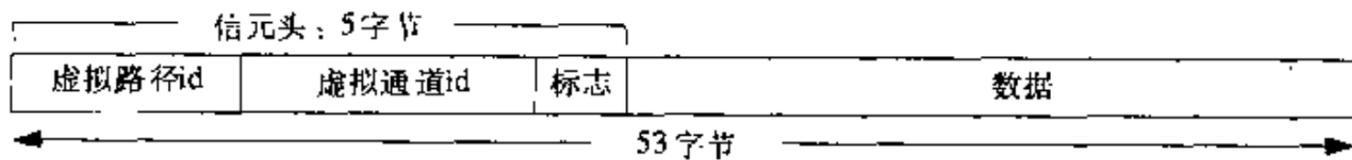
图3-24 ATM信元结构
