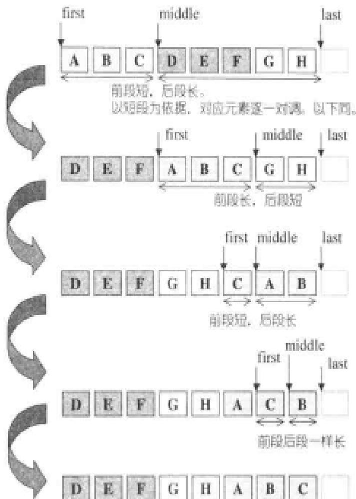
图 6-6h rotate forward iterator 版操作示意
